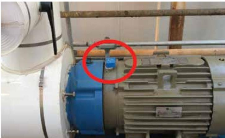
Рисунок 16. Двигатель с непосредственным приводом; монтаж над корпусом подшипника с приводной стороны
