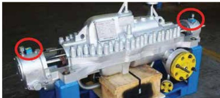
Рисунок 17. Межподшипниковый насос (BB3); монтаж на каждый корпус подшипника
