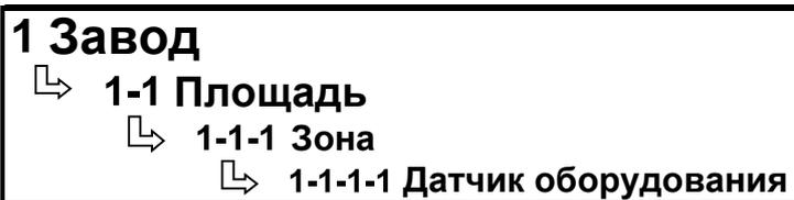
Рисунок 8. Пример иерархии оборудования для CMMS
