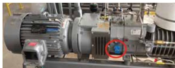
Рисунок 13. Объемный насос; боковой монтаж на раму
