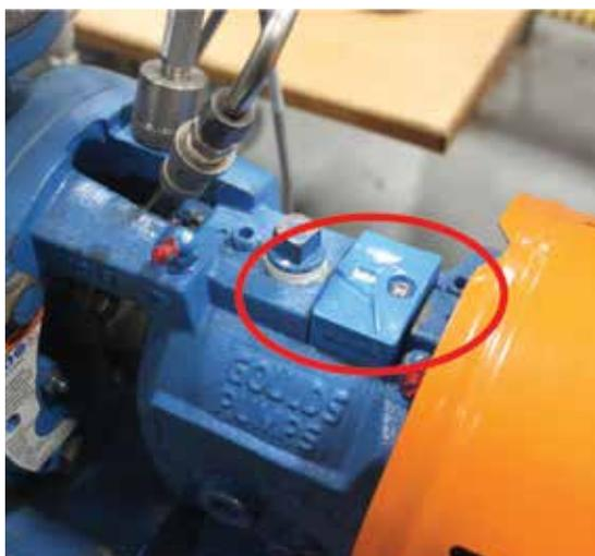
Рисунок 12. Насос ITT Goulds Pumps 3196 i-FRAME имеет фрезерованное гнездо для монтажа устройства контроля
