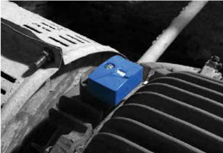
Рисунок 15. Горизонтальный двигатель; монтаж над корпусом подшипника приводной стороны
