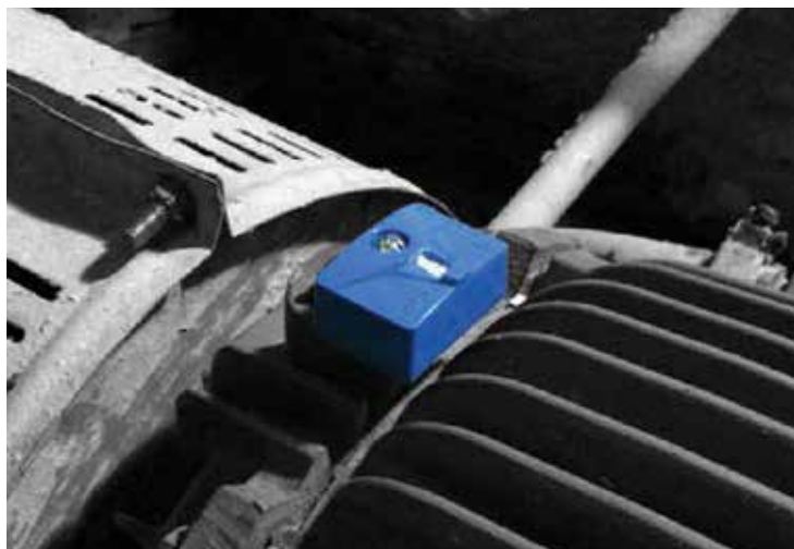
図 15: 駆動側のベアリングハウジング上に取り付けられた水平モーター
