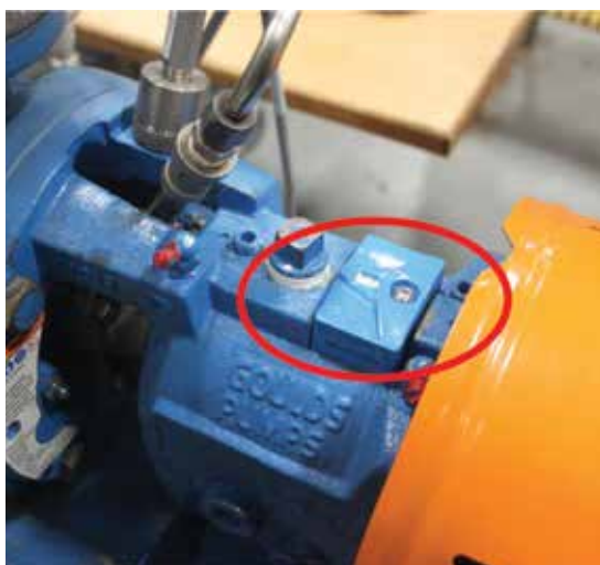
図 12: モニター搭載用のミルスロットを含む ITT Goulds Pumps 3196 i-FRAME
