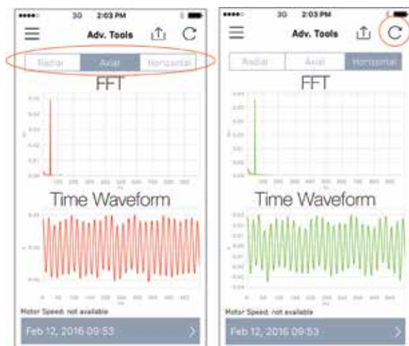
図 82: センサー軸間の切り替えまたはデータセットの更新要求
