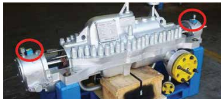
図 17: 各ベアリングハウジングに取り付けられたベアリング間ポンプ (BB3)
