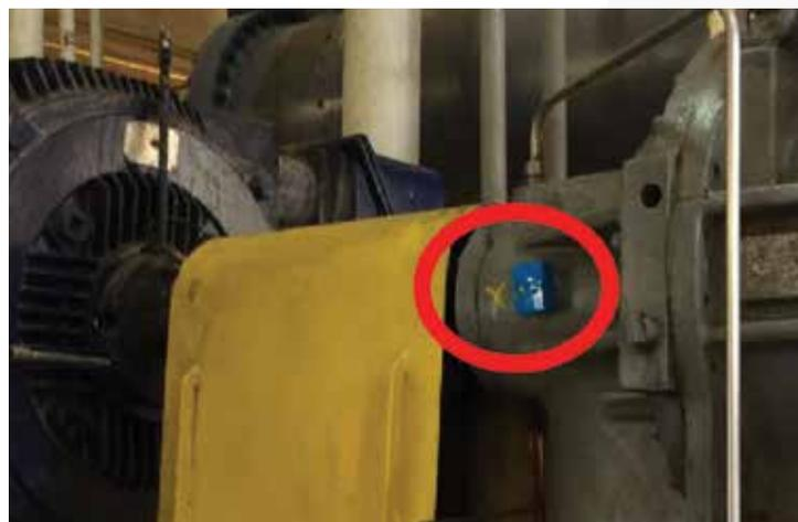
Figura 21: Bomba de vacío, montaje lateral en carcasa de rodamiento
