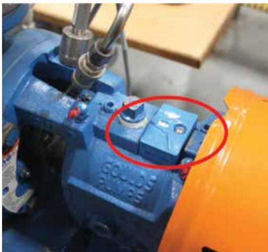
Figura 12: ITT Goulds Pumps 3196 i-FRAME contiene una ranura para montar el monitor
