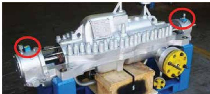
Figura 17: Bomba entre rodamientos (BB3), instalación en la carcasa de cada rodamiento
