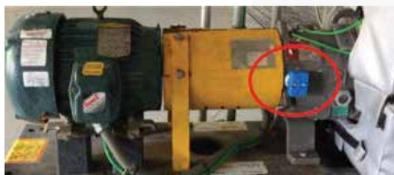
Figura 14: Bomba de procesos químicos, montaje lateral en estructura de rodamiento
