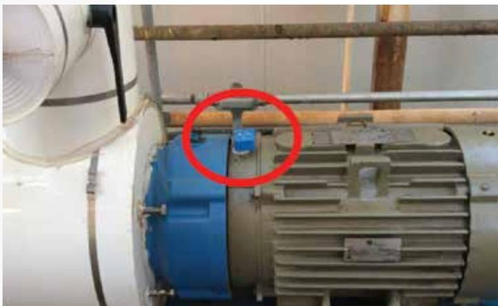
Figura 16: Motor de acoplamiento corto, instalado en la carcasa de rodamiento de extremo con motor
