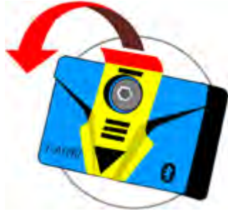
Figura n.: Activación del monitor de estado de equipos i-ALERT®2
