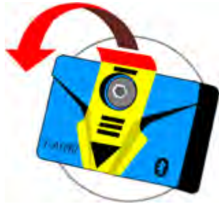
Abbildungsnummer 10: Aktivierung des Maschinenzustandsüberwachungsgeräts i-ALERT ® 2
