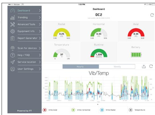
En raison du long intervalle de surveillance, la défaillance imminente n'a pas été détectée suffisamment tôt. La boîte de vitesses et le moteur ont été équipés de dispositifs i-ALERT2 pendant la réparation. Étant donné que l'i-ALERT2 est compatible Bluetooth, il est possible de communiquer sans fil avec un appareil mobile à une distance de sécurité de 10 à 30 mètres pendant que l'équipement fonctionne encore.
